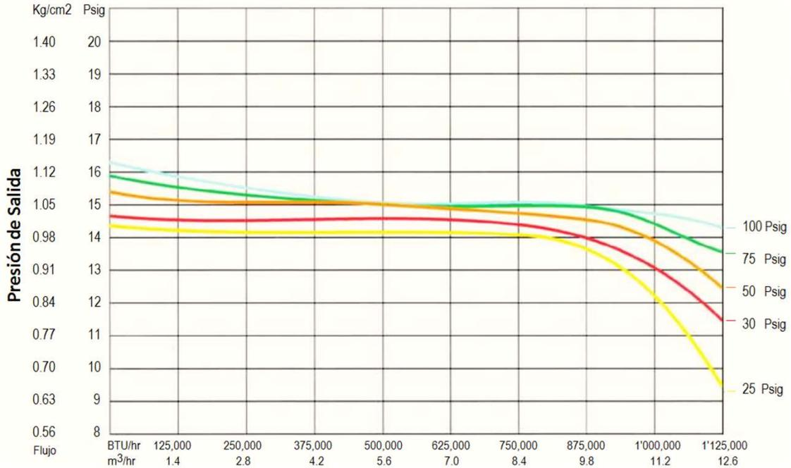
1. Determine la carga máxima de la instalación, considerando la demanda de todos los aparatos por alimentar y la presión regulada a la que va a conducir el gas incluyendo las caídas de presión.
