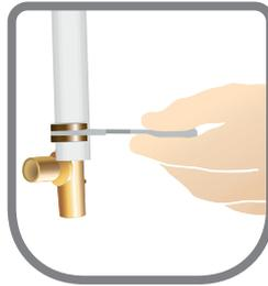
2. Posicionar la plantilla de verificación sobre el anillo de cobre, en ángulo de 90° respecto al tubo.
