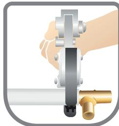
4. Colocar la pinza de modo que cubra completamente el anillo de cobre, presionar y cerrar.
