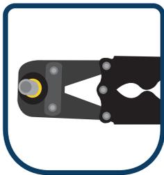
**5.** Cierre la herramienta de presión hasta que se unan los dos extremos de ésta. La herramienta cuenta con un tope de presión para evitar una mala instalación.
