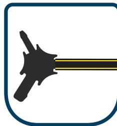
**2.** Introduzca el avellanador en el extremo de la tubería y gírelo 360° para biselar el interior del tubo y asegurar que las conexiones se puedan introducir con facilidad sin dañar o desplazar los "O-ring".
