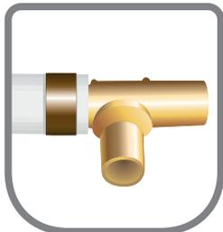
3. Insertar la conexión dentro del tubo hasta que tope y colocar el anillo de cobre a una distancia de entre 3 y 6 mm del borde o extremo del tubo.
