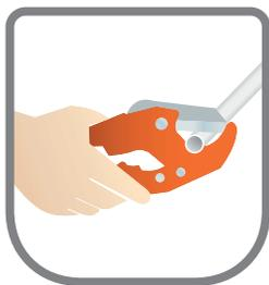
1. Asegurar el corte de forma perpendicular al tubo, ya que un corte mal realizado puede ocasionar uniones defectuosas.
