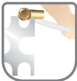
1. Verificar que se utilice la abertura correspondiente al diámetro del tubo. Realizar esta prueba en todas las uniones con la abertura de pasa (GO), y no pasa (NO GO)
