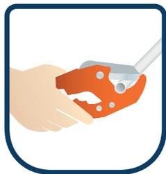
**1.** Corte la tubería verticalmente. Se recomienda utilizar el corta tubo adecuado para este tipo de tubería y asegúrese que las cuchillas estén en buenas condiciones.
