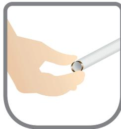
2. Colocar manualmente el anillo de cobre alrededor del tubo.
